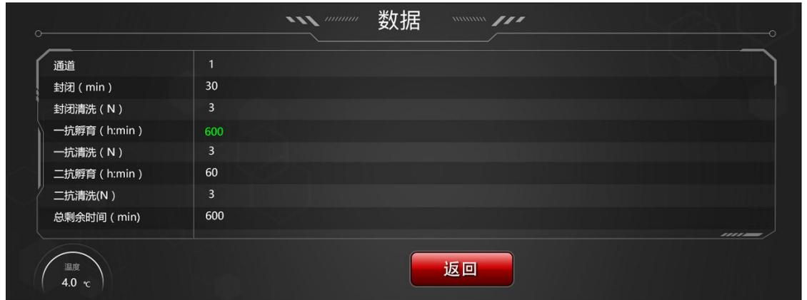
数据界面中将会显示所有正在实验及实验结束的参数，如上图所示。其中绿色数字代表实验正在进行该步骤。当剩余时间为 0 时代表实验运行结束。左下方温度表示当前抗体孵育盒仓内的温度。
